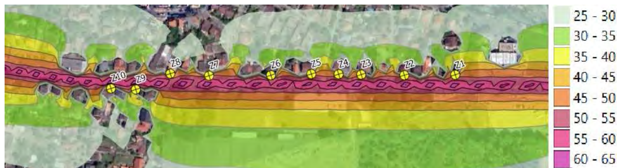
Z12. ábra Építési forgalommal az út környezetében fellépő hangnyomásszintek
