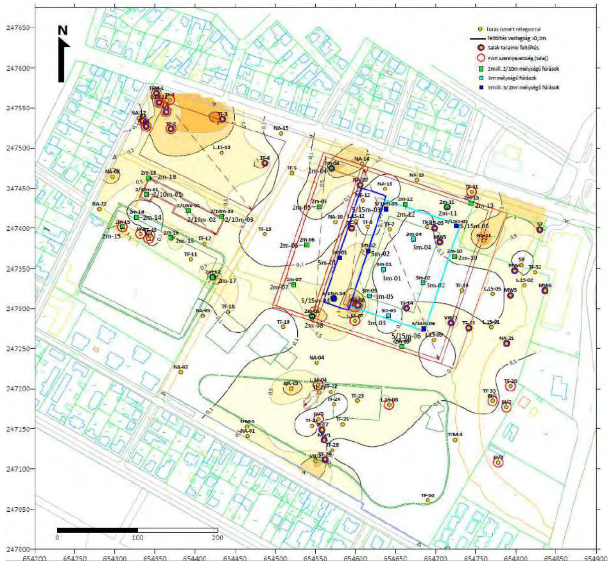
F.7. ábra – A területen mélyített fúrások összefoglaló bemutatása, izovonalasan megjelenítve a feltöltés vastagságát, valamint külön jelkulccsal a salakos rétegsorral jellemezhető, ill. PAH szennyezett fúrásokat
