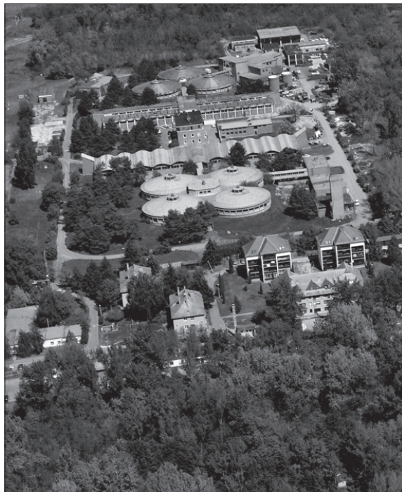
A Nagyfelszíni Vízmű légifotó részlete a déli négy, az északi három derítővel, a szűrőgépbázakkal és a kiszolgáló egyéb épületekkel
