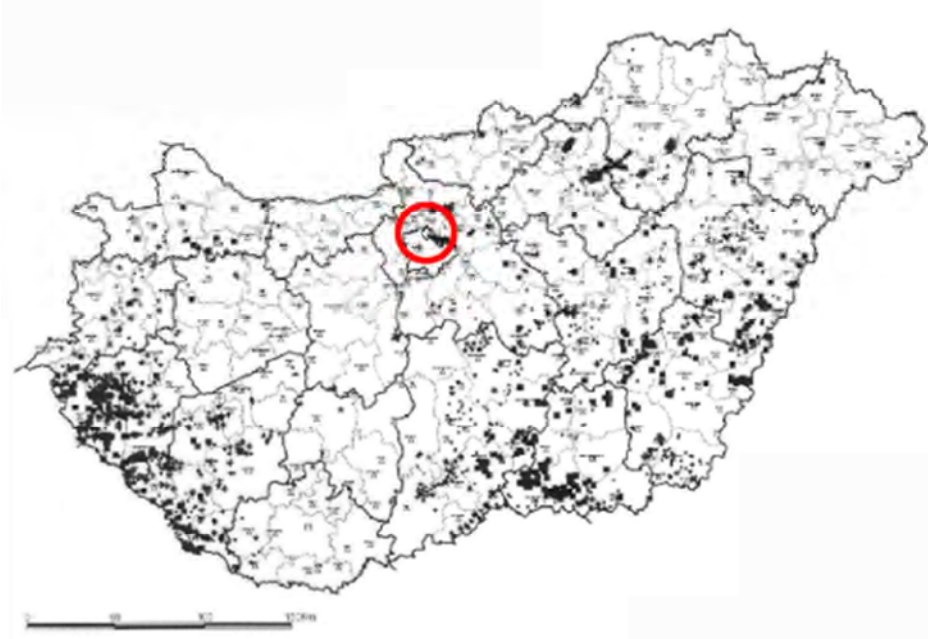
19. ábra: Magyarországon geotermikus energia hasznosítási lehetőség a felhagyott CH meddő kutak – Magyarország CH meddő kútjainak területi megoszlása
